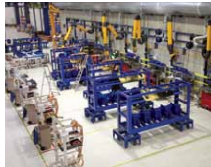
Montagelinie für Carrier CO 2 OLtec™-Verbundkältesätze, Frankreich
